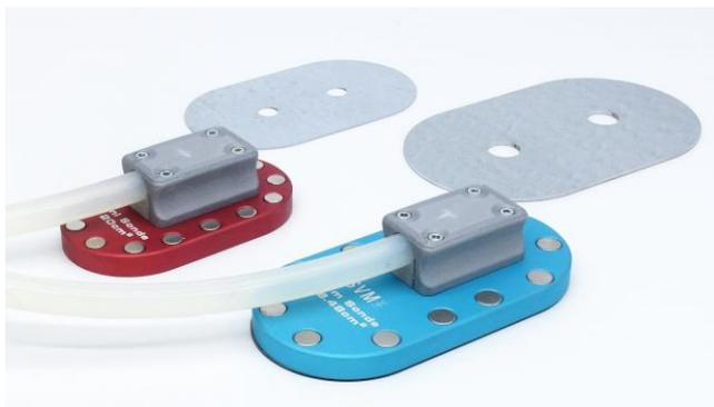
Für die Messungen stehen zwei verschiedene Mess-Sonden zur Verfügung. Die Standard-Sonde hat eine Messfläche von 38,5cm<sup>2</sup> und entspricht damit dem herkömmlichen Messverfahren. Eine kleinere Messsonde mit 20cm<sup>2</sup> ermöglicht die Messung an unzugänglichen Stellen. Über einen Schalter am Gerät kann die verwendete Sonde ausgewählt werden.
