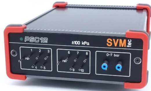
Kundenspezifische Variante mit zus. Hochdruckkanälen
