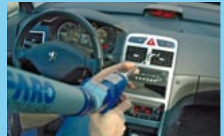
Messung der Austrittsgeschwindigkeit aus den Mitteldüsen (Messzeit insgesamt: 3 Minuten)
